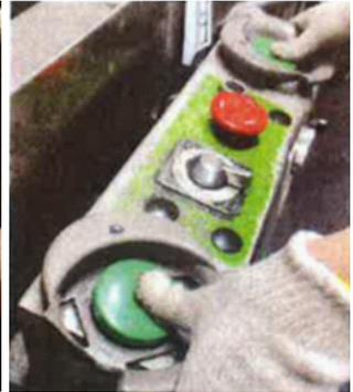
写真1.(左) 他社のプレス作業の状況：奥の固定台の上に材料をセットし、手前の操作盤の2つの起動ボタンを、両手の親指で押下して金型を下行させる。
