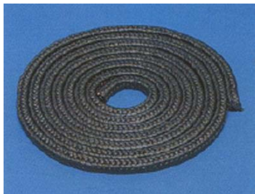
写真 2.5 石綿含有角打グラウンドパッキン
