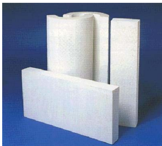
写真 2.9 石綿含有保温材
