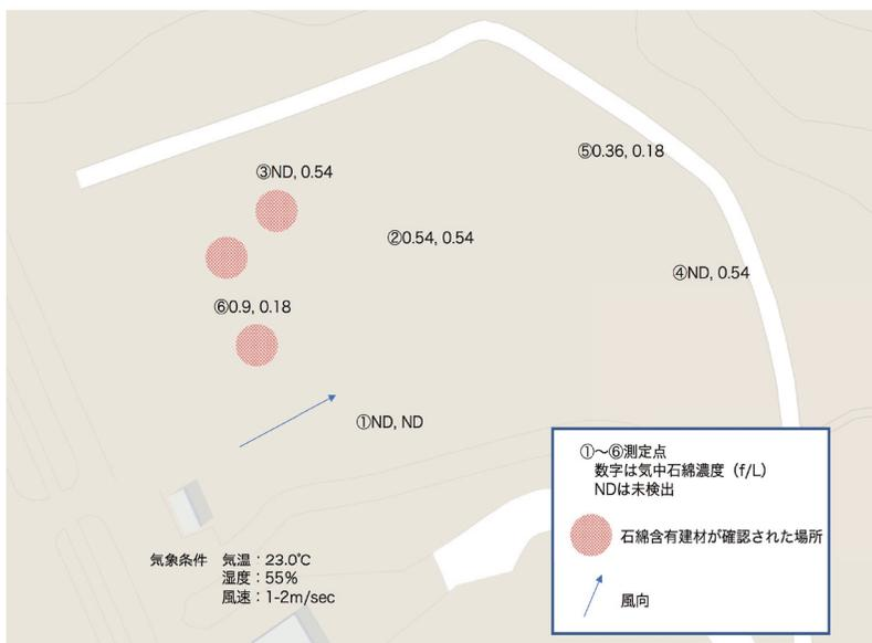
図4 熊本市災害廃棄物仮置場での気中石綿濃度測定結果(2017.9.1)
