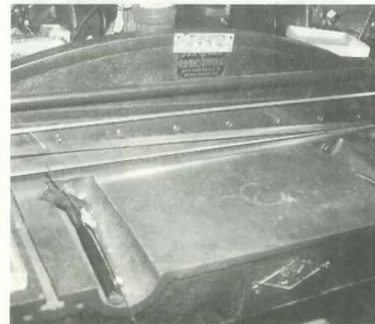
図1 シャーリングに設置された安全装置
